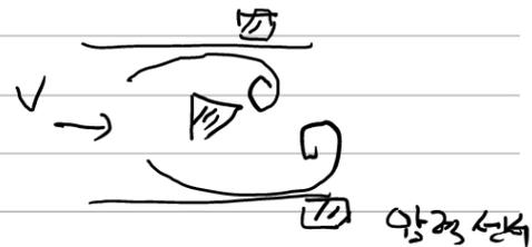
구조를 설치. 번갈아 가면서 번갈아는 와류 주파수와 유속 관계를 유량을 측정
